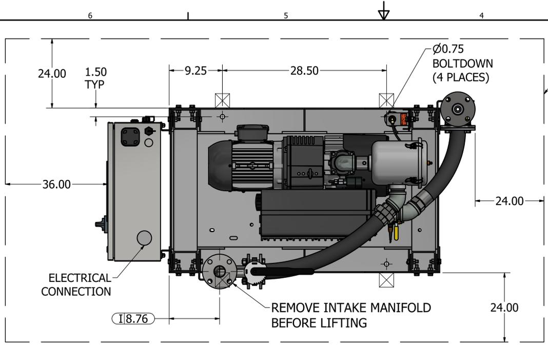
MINIMUM CLEARANCE FOR MAINTENANCE & VENTILATION
