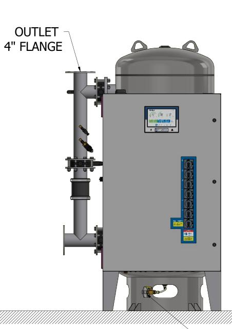
TANK DRAIN LOCATION-CONTRACTOR SHALL PIPE TO FLOOR DRAIN
